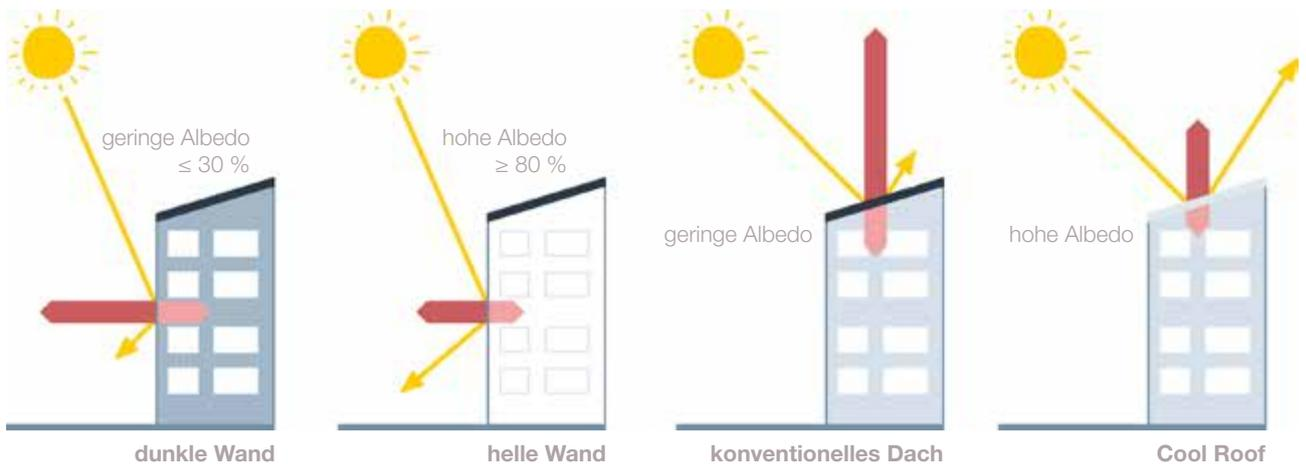
Abb. 142: Albedo von unterschiedlichen Fassaden- und Dachoberflächen
